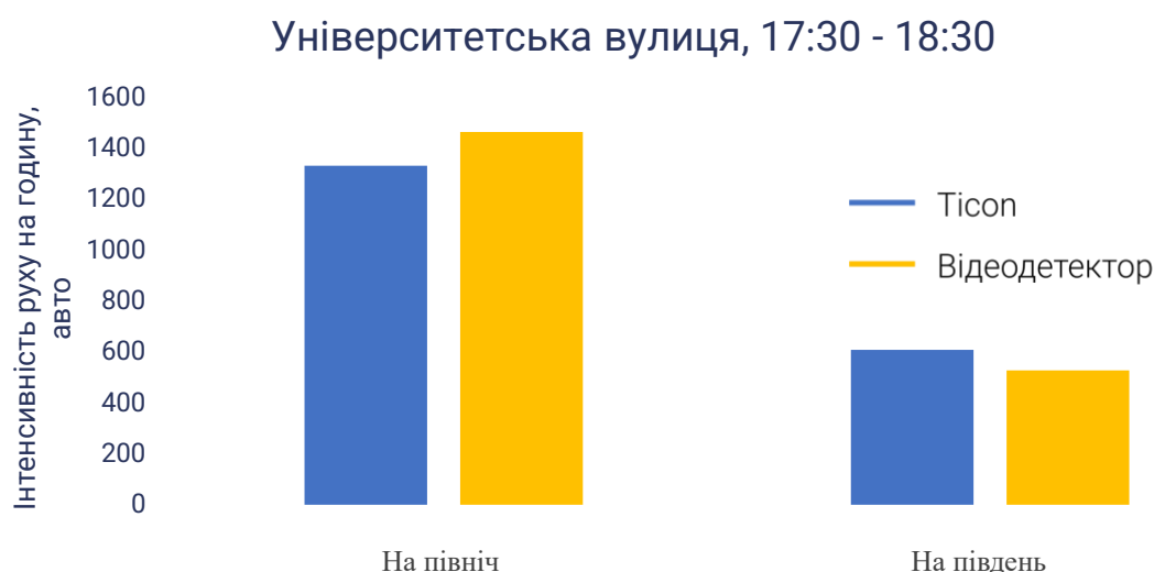
Рис. 5 Верифікація точності оцінки повного об'єму транспортного потоку
