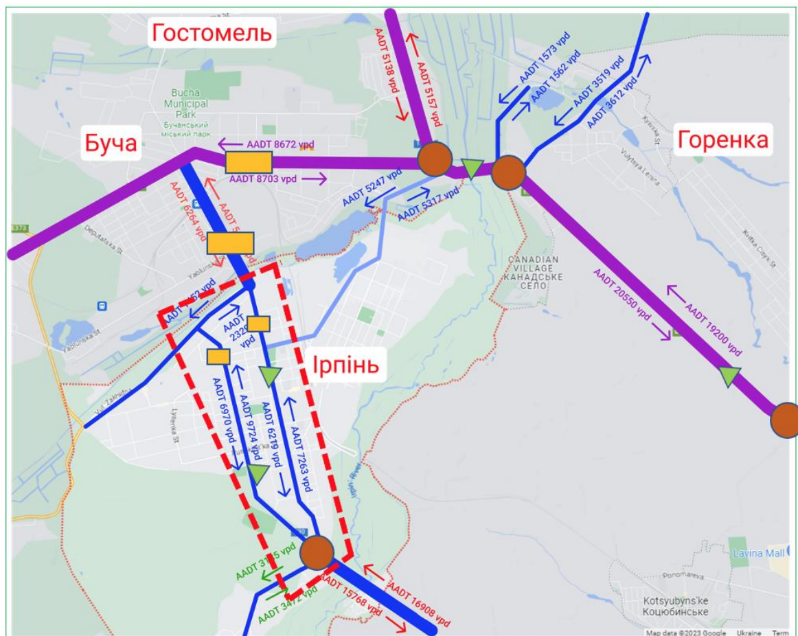
Рис. 10 Схема оптимізованої організації дорожнього руху в Ірпінській агломерації
